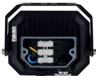
Connecteur interne + presse-étoupe + valve anti condensation
